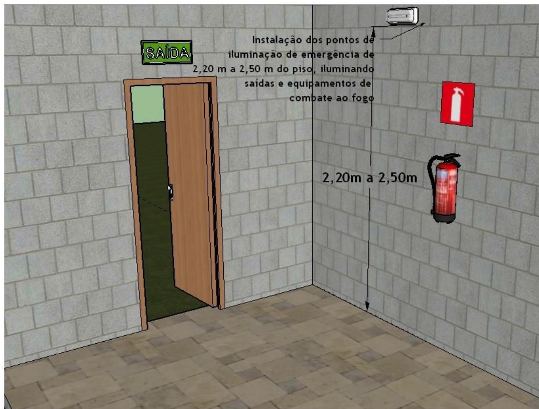
Instalação dos pontos de iluminação de emergência
